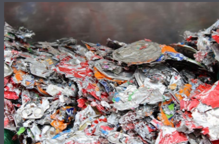
AL Dosen nach Entwässerung
