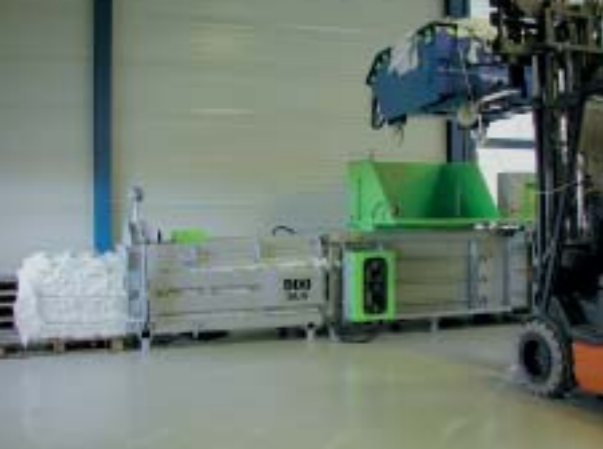
...Befüllung durch Stapler und Kippbehälter
