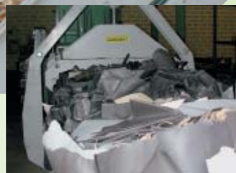
Über die Presskanalsteuerung kann für jedes Material der geeignete Kanaldruck erzeugt werden.
