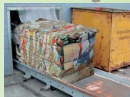
Eine von vielen Möglichkeiten: Abtransport der fertigen Ballen über eine Ballenrutsche nach außen - zum Ballenzwischenlager.
