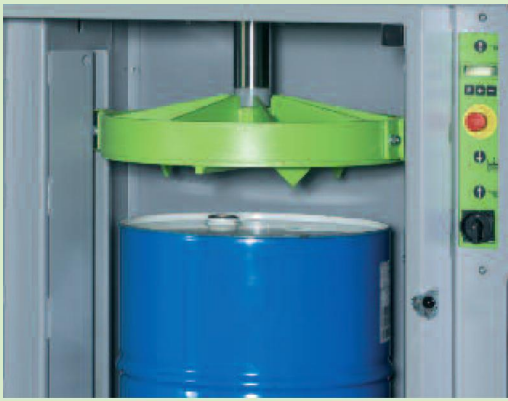
Großer Press-Stempel: Mit Belüftungsdornen und beidseitiger Führung.
